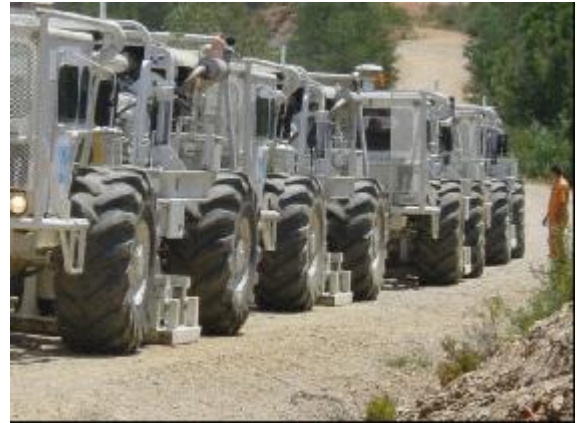
Ilustración 3 Sísmica terrestre, usando como fuente de poder los vibradores. Arreglo de camiones que posan sobre el terreno vibradores para golpear la superficie y hacerla vibrar controladamente y que generan frentes de ondas que serán captadas por geófonos y registrados en formatos digitales
